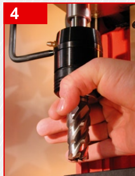
Rys. 3: Wiertło koronowe znajduje się w EasyLock. Obrabiarka jest przygotowana do pracy.
